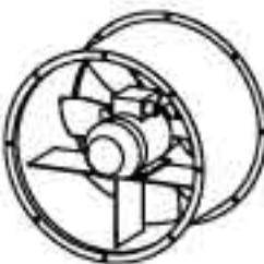
\* вентилятор может комплектоваться защитной решеткой, подставкой, взрывобезопасным двигателем
