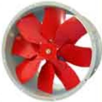
Цилиндрический корпус выполнен из оцинкованной стали или стали с полимерным порошковым покрытием. С обеих сторон корпуса имеются фланцы стандартных размеров с отверстиями для крепления к круглым воздуховодам. Лопатки рабочего колеса выполнены из стали или алюминия. Вентилятор оснащен трехфазным асинхронным двигателем, класс защиты IP54.
